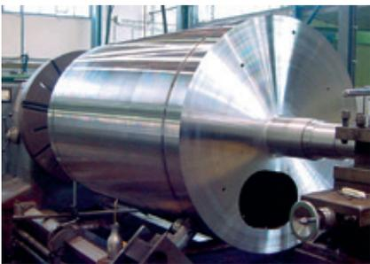
Je nach Einsatzzweck der Walzen kommen Stahl, Edelstahl, Aluminium oder Sonderwerkstoffe zum Einsatz. Der stets in Erweiterung befindliche Maschinenpark ermöglicht derzeit Dimensionen von bis zu 4.200 mm Durchmesser und 18.000 mm Länge.
