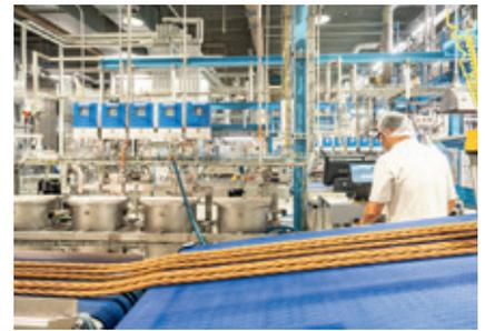
Extrusionlinie für die Herstellung der Spezialsnacks
