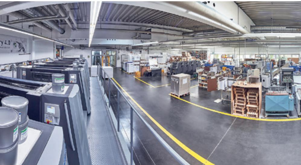
Automatisierungsmodule erleichtern die Arbeit der Medientechnologen und beschleunigen die Abläufe an der großen Offset-Druckmaschine erheblich. Hinzu kommt die hohe Verarbeitungsgeschwindigkeit von bis zu 15.000 Druckbogen pro Stunde.
